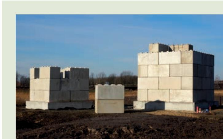
Der Dauerbelastungsstand der G<sup>2</sup> Gruppe Geotechnik an der A72
