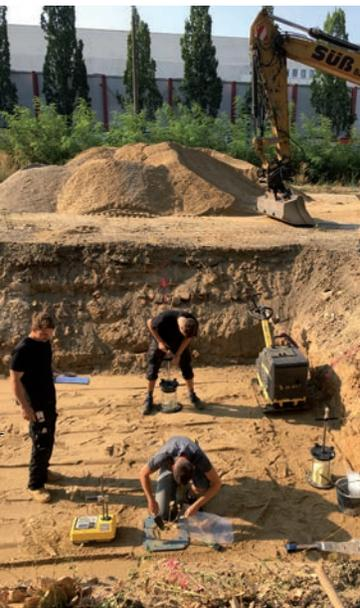
*Prüfung der Einbaudichte
