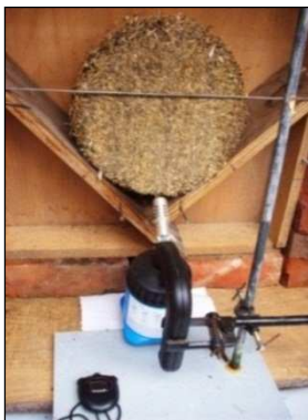
Abb. 4: Prüfeinrichtung zur Kantenbeflammung
