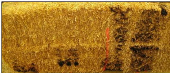
Abb. 1: links: Boraxlösung; rechts: unbehandelt
