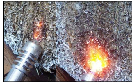
Abb. 9: Prüfkörper mit Kalialaun behandelt, links: Beflammung B2-Prüfung, rechts: Erhöhung der Flammintensität, keine Flammenentwicklung
