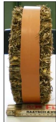
Abb. 3: Seitenansicht Prüfkörper (Rohrsegment b = 40 \text{ mm} )
