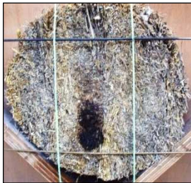
Abb. 5: Flächenbeflammung, Bsp.: Teilversuch \rho = 143 \text{ kg/m}^3 gestutzt, Prüfung bestanden
