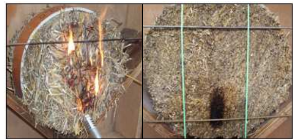
Abb. 7: Vergleich Schadensfläche Flächenbeflammung: links: unbehandelt - sofortiges Hochbrennen, rechts: Dichte \sim 200 \text{ kg/m}^3 und gestutzte Oberfläche
